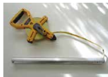
上下のボールが弁となり、筒に取り込んだ水を閉じ込めます
